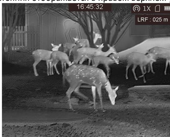
Рис. 6-1. Результат измерения расстояния
