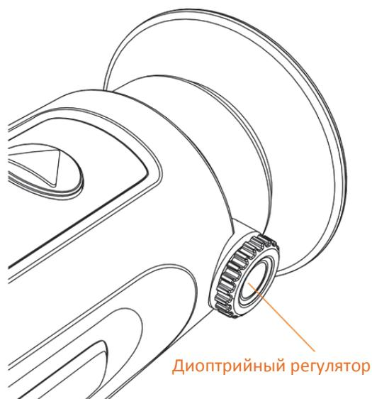
Рисунок 3-2. Регулировка диоптра
