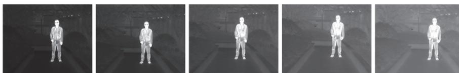
Рисунок 3-4. Регулировка яркости в режиме «горячее – белое»
